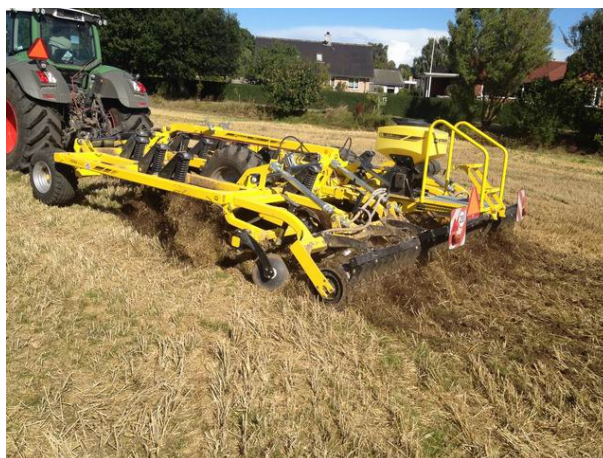
(Udstilling) Strom-Bednar Fenix FO 5000 –5 meter, 4 rækket, bugseret tandharve med støttehjul/rulle
