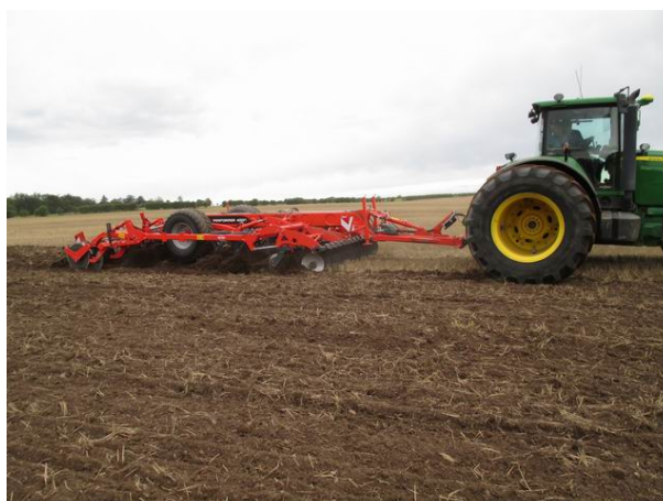
KUHN – Performer 4000 – multistubharve bugseret (2 x disc + 30 cm + 14 tands 30 cm med 600 kg udløser effekt) + 700 mm stålpakker
