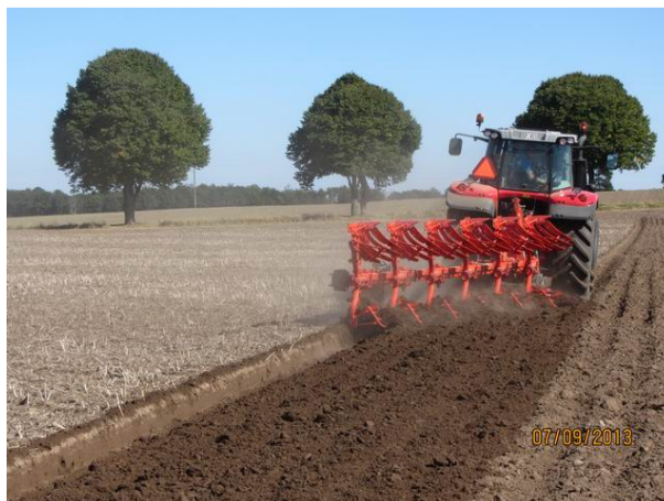
Kuhn – Vari Master 153/6NSH – hydraulisk hældning vendehoved + HD-Tronic (hydraulisk landhjul)
