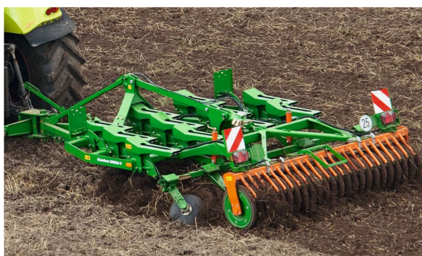
Cenius 4002-2T bugseret foldbar stubharve. Harve med 14 tænder fordelt på 3-tandrækker. Harvedybde ned til 30 cm med mulighed for montering af spidser/skær i forhold til den valgte opgave og arbejdsdybde. Tandsporsudjævnere med tallerkner og flexline pakvalse. Harven kan udstyres med Greendrill for såning af mellem- & efterafgrøder samt raps
